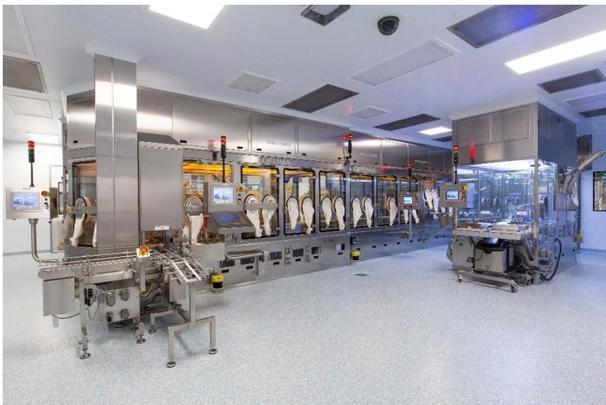
Speziell für kleinere bis mittlere Batches sowie für hochpotente Arzneimittel wurde der OPTIMA MultiUse Filler konzipiert. Für höchste Flexibilität verfügt die modulare Maschinenplattform unter anderem über Robotertechnologie.
