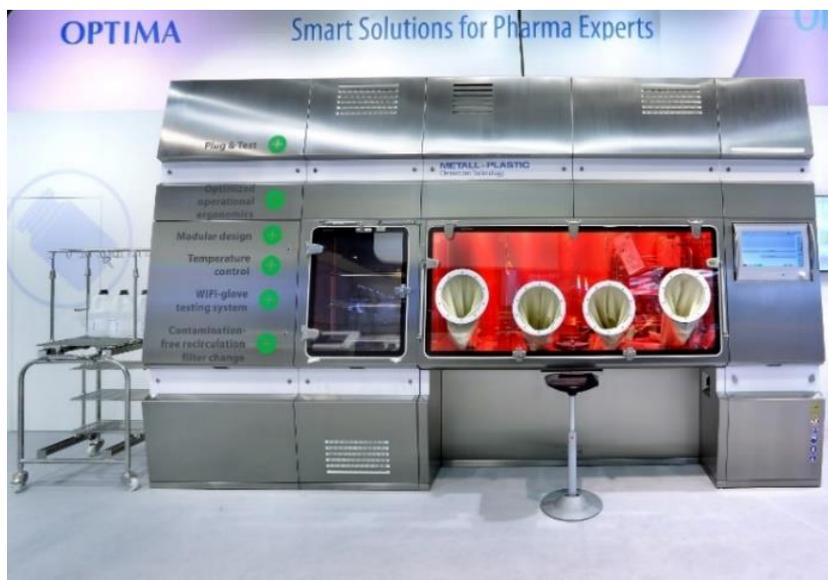
Der Sterilitätstestisolator STISO von Metall+Plastic überzeugt mit schnellen Dekontaminationszeiten. Auch die ergonomische Gestaltung sowie der modulare Aufbau bieten den Anwendern Vorteile.
