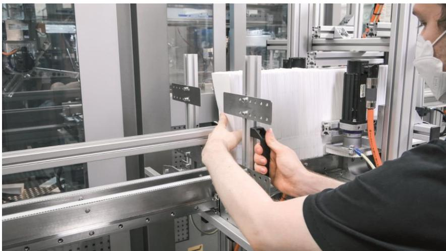
Alle Maschinenlösungen von Optima Nonwovens sind flexibel für unterschiedliche Packmaterialien umstellbar. Hier werden Papierbeutel für die Verpackungen von Damenbinden in die Maschine eingelegt. (Quelle: Optima)
