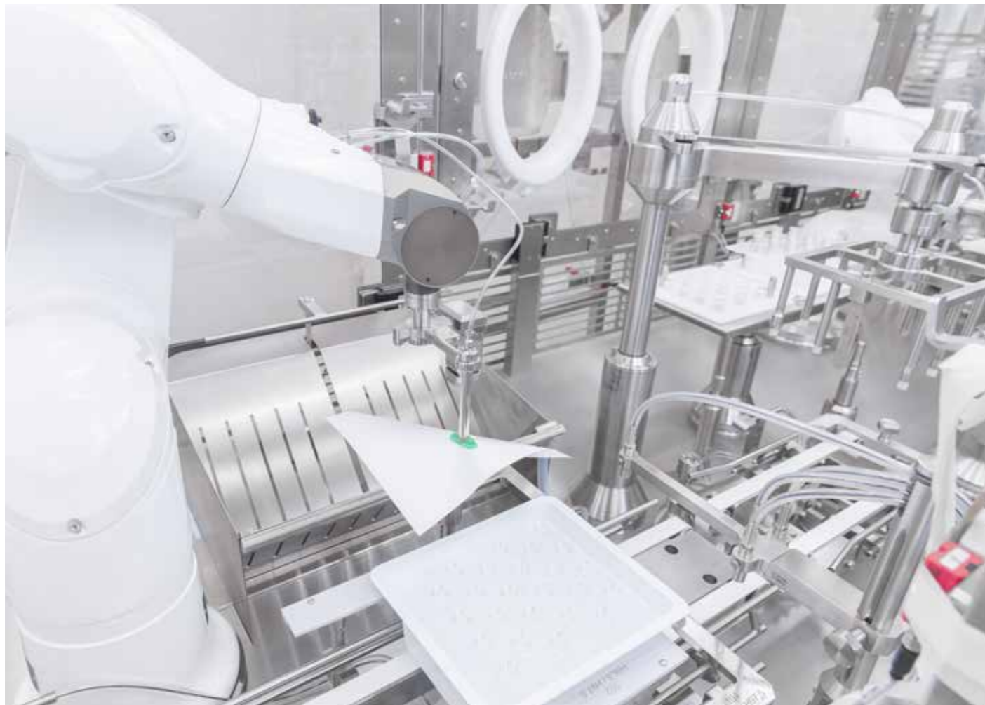
Roboter meistern feine Bewegungen, etwa beim Entfernen der Tyvekfolie, die sterile Behältnisse schützt.
