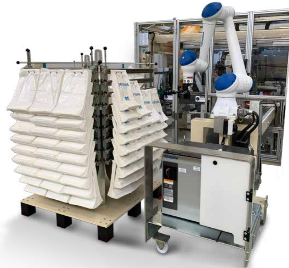
Mit dem Trend zur Vollautomatisierung entstehen Einsatzfelder für Cobots, etwa das Auflegen von Beutelstapeln auf die Beutelaufgabe. Die äußerst effiziente Lösung von Optima Nonwovens kommt ohne zusätzliche Sicherheitssysteme wie etwa Scanner oder Sicherheitssensoren aus.
