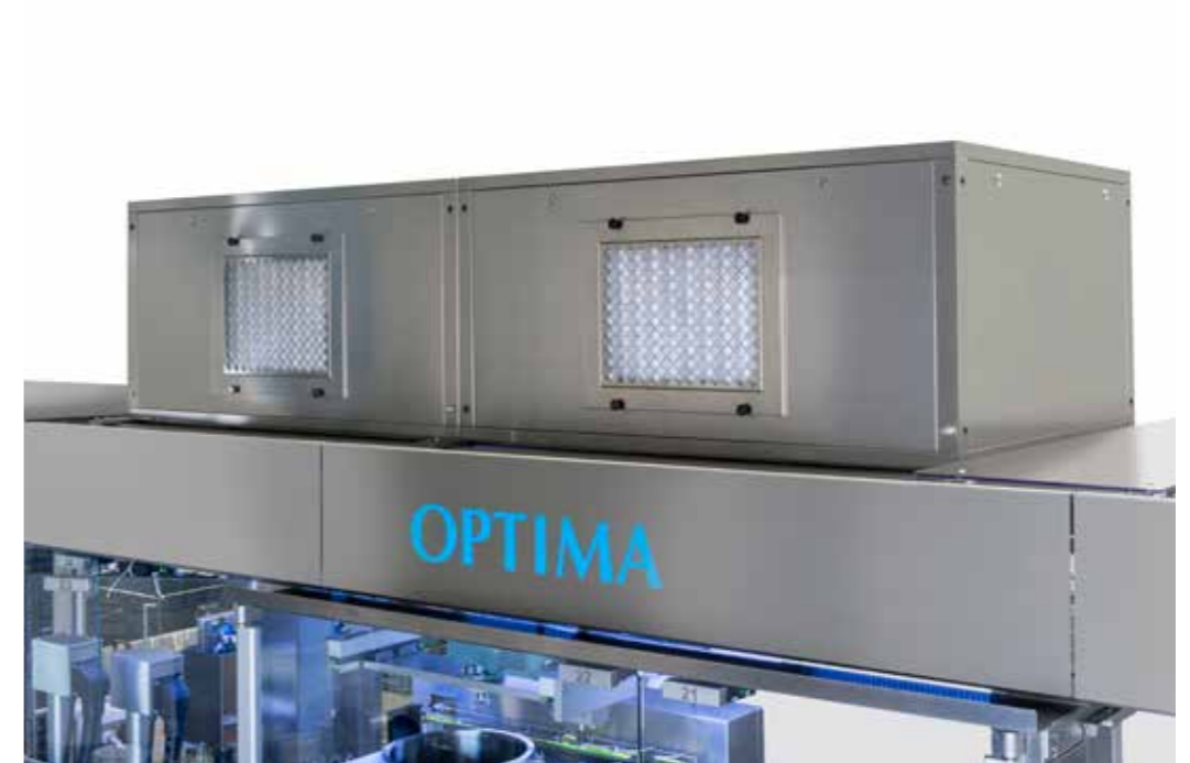
^ Mehrere Komponenten wurden unter Optima Regie in die Anlage integriert, darunter die Laminar-Flow-Einheit eines französischen Herstellers.
