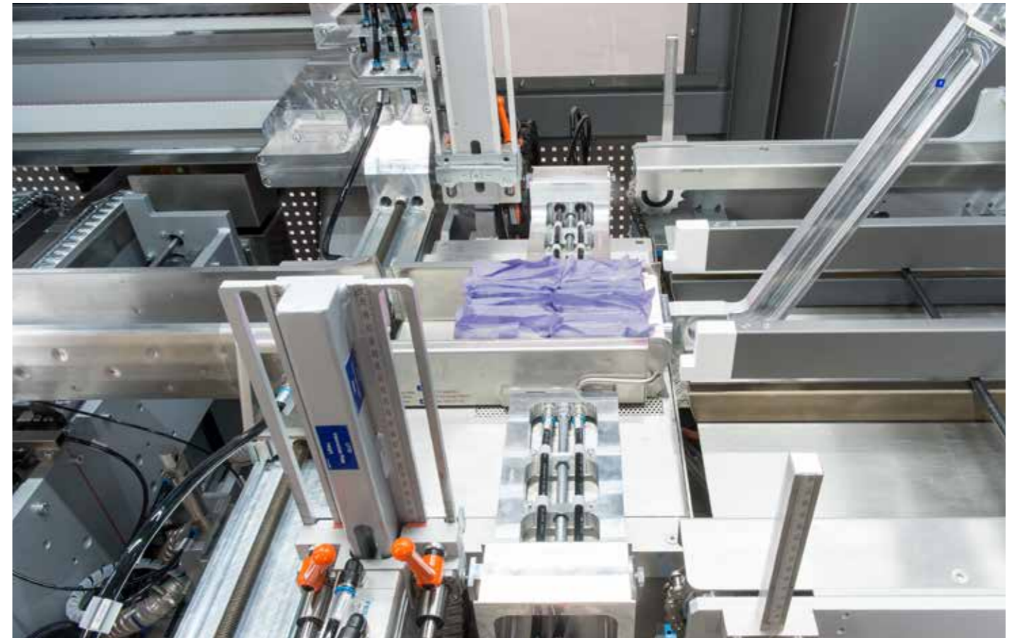
^ Mit der OPTIMA Zero L1, die auf der neuen Zero Plattform aufbaut, sind unterschiedliche Produktformationen und Packungsgrößen einfach zu realisieren.
