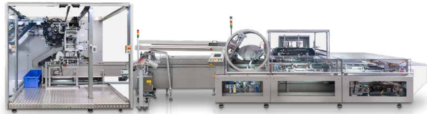
^ Die Sekundärverpackung – hier mit Kartonierer – lässt sich in den Inlineprozess integrieren.
