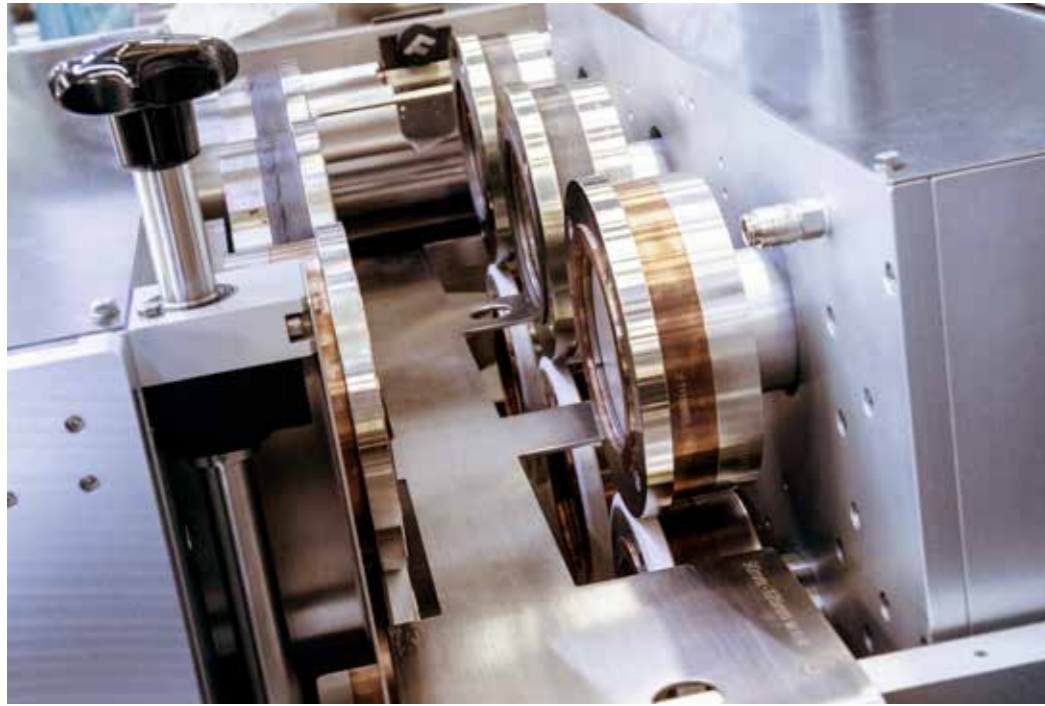
^ Siegelstation: Die Vierrandsiegelbeutel werden in einem kontinuierlichen Prozess versiegelt.
