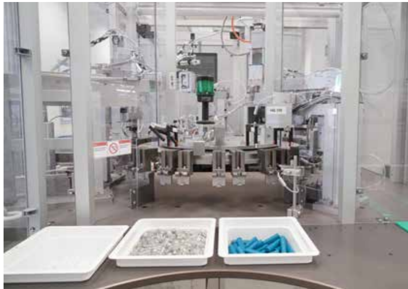
^ Nach dem manuellen Einsetzen der Komponenten folgt der automatisierte Montageprozess. Das Maschinenkonzept ist auf eine nachträgliche Vollautomatisierung vorbereitet.
