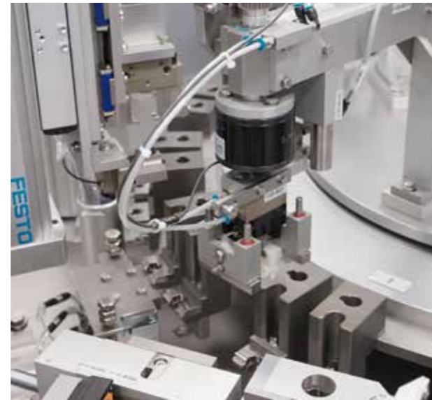
^ An der Rundtaktmaschine sind alle Verarbeitungsstationen integriert: Hier wird der Knopf des Dosiermechanismus in die Grundstellung zurückgedreht.
