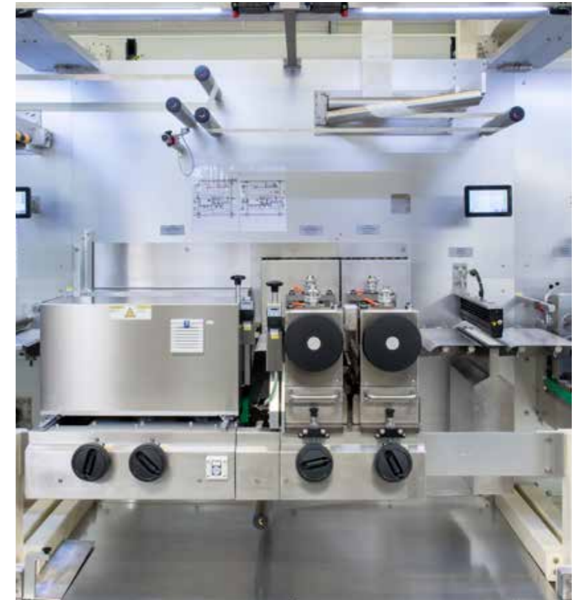
> Kleine Monitore geben Einstellwerte vor, die manuell eingerichtet und bestätigt werden müssen. Zuvor erfolgt die Rezeptauswahl am HMI.
