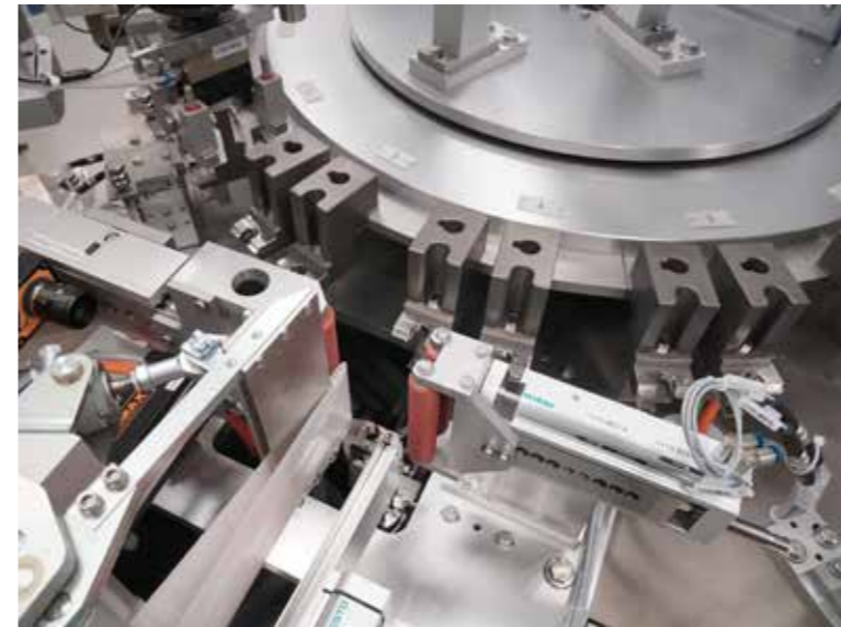
^ An dieser Station wird der Dosiermechanismus des Pens eingepresst.
