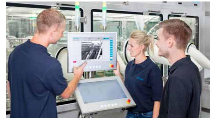
Kameras ermöglichen die Beobachtung des Maschineninnenraums, schnelles Eingreifen und Analysen.
