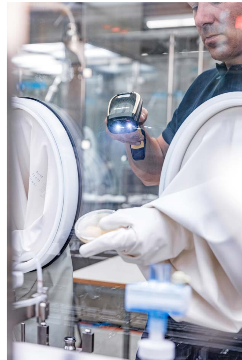
Mit einer neuen digitalen Lösung von Optima Pharma lassen sich die Agar-Platten einscannen und zweifelsfrei zuordnen, Timing-Funktionen sind ebenfalls integriert.
