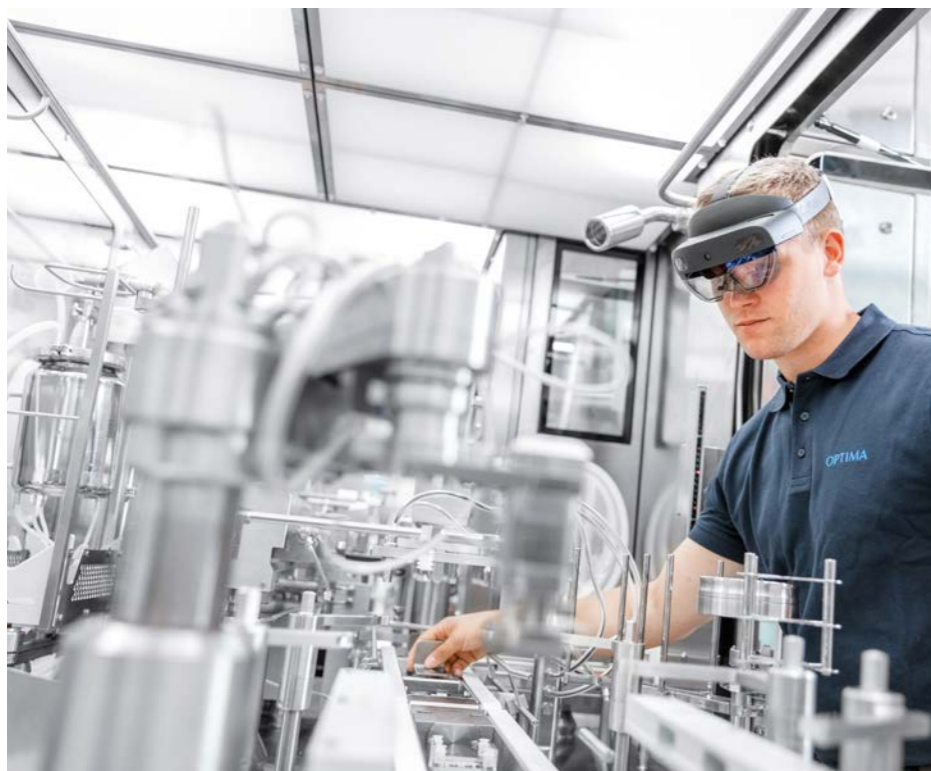
Beim Troubleshooting immer an der Seite des Kunden: Mit Augmented-Reality-Brillen sehen die Optima Serviceexperten, was der Anlagenbediener sieht und können gezielt unterstützen. Wichtige Informationen lassen sich ins Sichtfeld einblenden.
