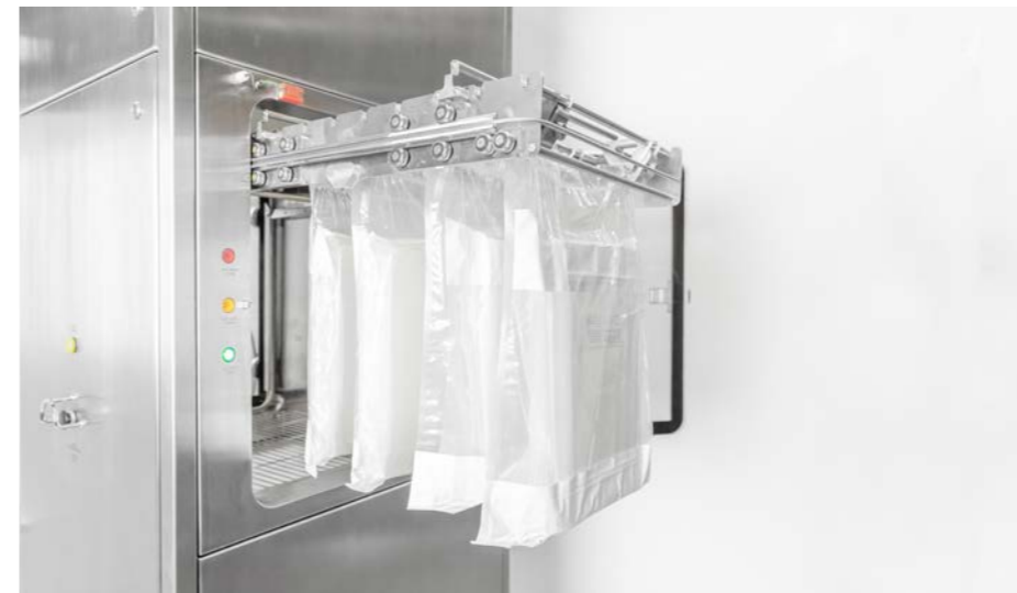
Material-Transfer-Schleuse für Komponenten. Zudem können Vials bis zur Größe von 100R auf der OPTIMA FillCell verarbeitet werden.
