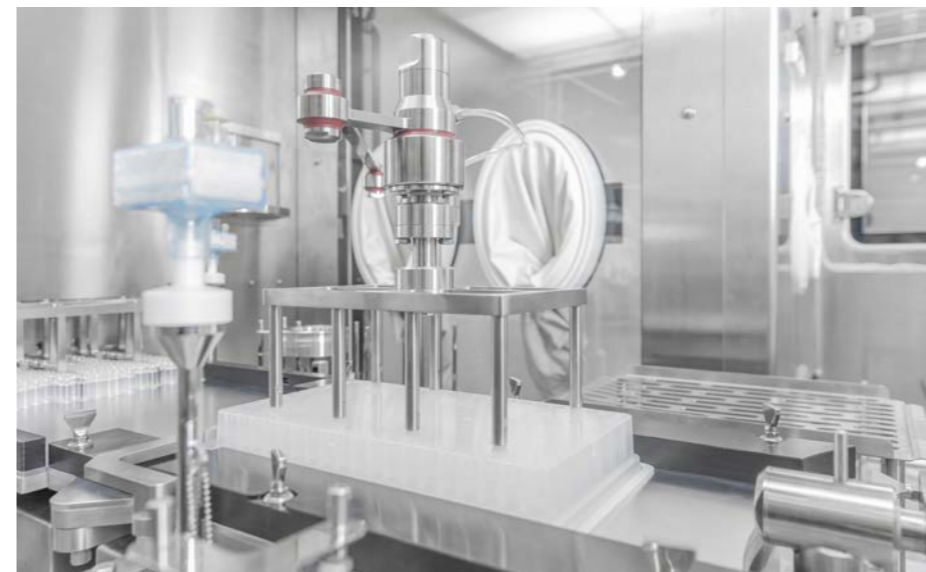
Die Trays der Vials werden automatisch mit einem Roboter entfernt, bevor die Vials in die spezifische lineare Zuführung übergehen.
