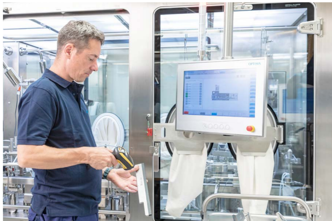
Produktionsstopps aufgrund von Bedienungsfehlern sind in der Pharmabranche kostspielig. Abhilfe schafft ein digitaler Formatwechselassistent von Optima Pharma. Optional können zu wechselnde Formateile abgescannt werden, was die Prozesssicherheit erhöht.
