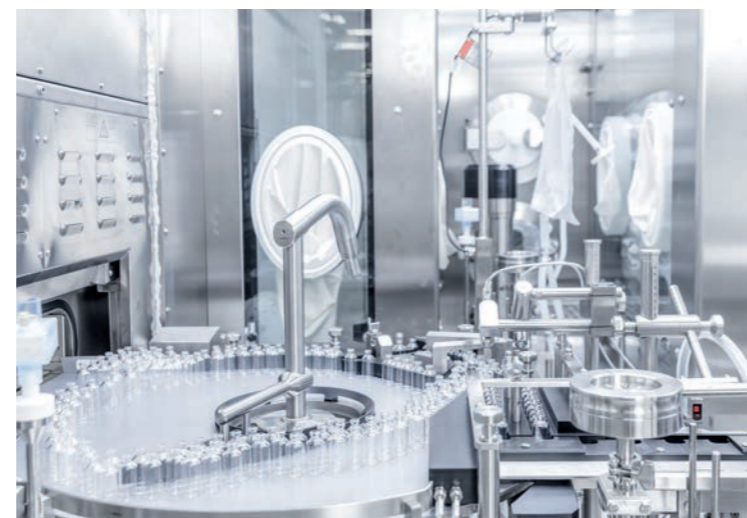
↑ Nach dem Sterilisiertunnel folgt der Übergang in den isolatorgeschützten Füllbereich.
