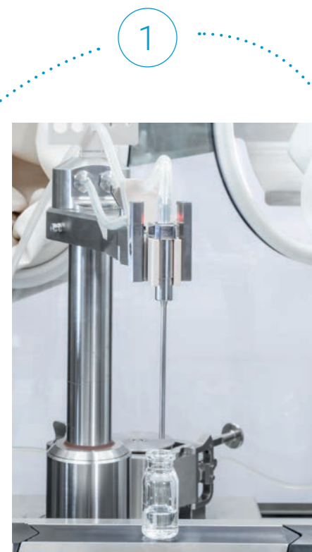
↑ Produktparfunktionen vom Füllen bis zum Verschließen: Die Einzelverarbeitung eröffnet die Möglichkeit, einen Verarbeitungsvorgang zu wiederholen, statt ein Behältnis zu verwerfen. Die MultiUse LAB eignet sich damit für die Parameterentwicklung für MultiUse-Anlagen mit höherer und hoher Ausbringung sowie für die Verarbeitung sehr teurer Arzneimittel in kleinsten Batches.
