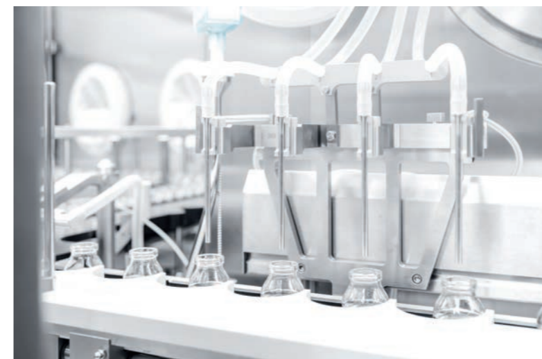
↑ Bis zu 5.000 Vials werden pro Stunde verarbeitet. Produktparfunken schöpfen die vorhandene Menge der Arzneimittel optimal aus.
