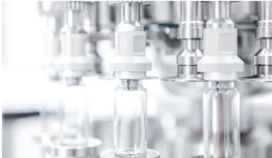
→ Vials werden gebördelt. Diese Station ist so platziert, dass zuvor noch ein Gefriertrocknungsprozess eingebunden werden könnte, sollte sich bei INCOG der Bedarf dafür abzeichnen.
