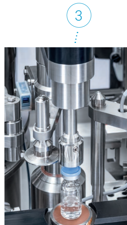
↑ Produktparfunktionen vom Füllen bis zum Verschließen: Die Einzelverarbeitung eröffnet die Möglichkeit, einen Verarbeitungsvorgang zu wiederholen, statt ein Behältnis zu verwerfen. Die MultiUse LAB eignet sich damit für die Parameterentwicklung für MultiUse-Anlagen mit höherer und hoher Ausbringung sowie für die Verarbeitung sehr teurer Arzneimittel in kleinsten Batches.
