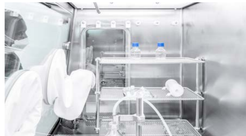
↓ Innensicht: Materialtransferschleuse (MTC) mit pneumatisch dichtender Schiebetür
