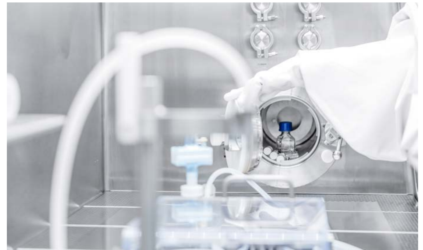
↑ Materialtransfer über optionalen RTP-Port
