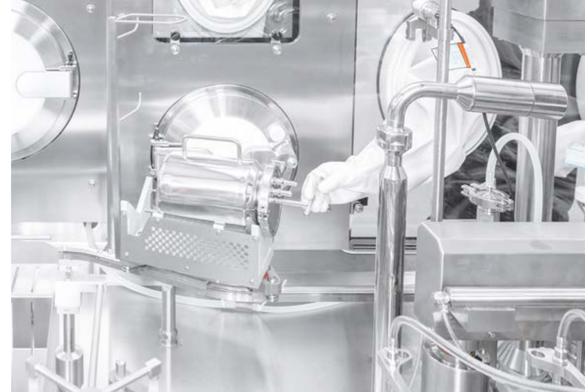
→ Handling- und Übergabelösung für autoklavierte Rotationskolbenpumpen im Isolator: Mit so genannten Peak-Vorrichtungen lässt sich die Installation der Rotationskolbenpumpen ohne direkten Kontakt mit produktberührenden Materialien realisieren.
