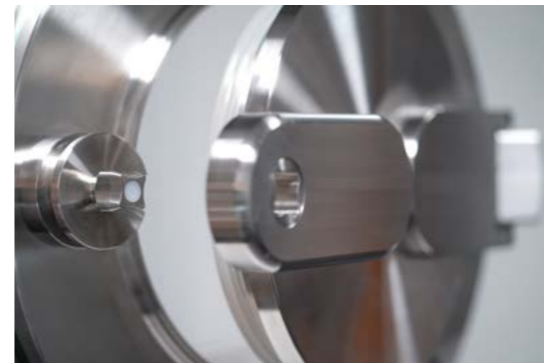
→ Handling- und Übergabelösung für autoklavierte Rotationskolbenpumpen im Isolator: Mit so genannten Peak-Vorrichtungen lässt sich die Installation der Rotationskolbenpumpen ohne direkten Kontakt mit produktberührenden Materialien realisieren.
