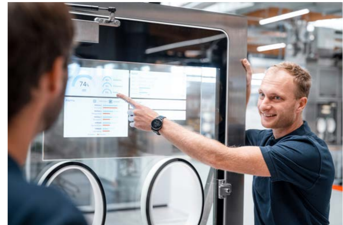
Ein neuartiges OLED Panel in Isolatorscheiben ist bedienbar, zeigt Informationen und Videoanleitungen an. Bei Nichtgebrauch ist es transparent.
