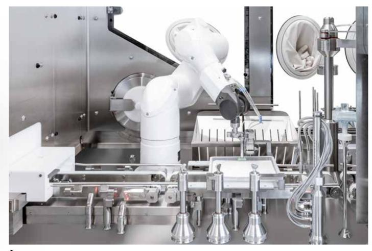
Der Tyvek Removal Roboter zieht die verschweißte Folie vom Nest ab, bevor die darin enthaltenen Behälter vereinzelt werden.
