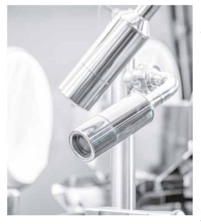
Das Video Monitoring ermöglicht die kontinuierliche Aufzeichnung des Füllprozesses und speichert Filmsequenzen im Alarmfall.
