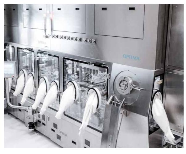
einen Teil der gesamten komplexen Isolatortechnik zeigen. Gewissermaßen unsichtbar befindet sich über dem Isolator im Technikgeschoss die HVAC-Einheit (HVAC: Heating, Ventilation and Air Conditioning). Könnte man auf die große HVAC-Einheit und die umfangreichen Verrohrungen verzichten, ließe sich der Aufwand im Isolatorbau sowie der reduzieren. Metall+Plastic ist es gelungen, wesentliche Funktionen des
