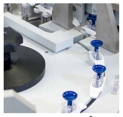
Eine zweite Optima Anlage bei USV India montiert Safety Devices. Zudem werden die Spritzen etikettiert.
