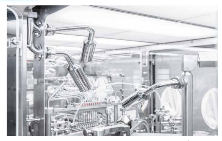
Ein wachsames Auge auf die Produktion: Kameras im Inneren der Füll- und Verschließanlage zeichnen jeden Schritt auf.
