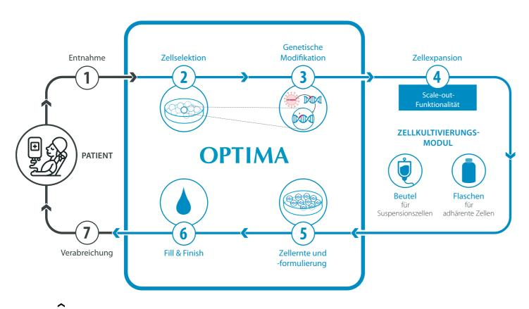
Das Stuttgart-Heidelberger ProCell-for-Patient-Modell sieht vor, dass wesentliche Schritte (blau) der Herstellung von Zelltherapeutika vollautomatisch in einem Isolator ablaufen. Der Prototyp wird im Robert-Bosch-Krankenhaus Stuttgart installiert.
