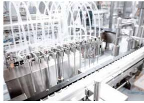
Durch die Kombination verschiedener Verfahren meistert die Linie die Dosierung von vier Medien mit sehr unterschiedlichen Eigenschaften – von der Sprühdosierung einer Flüssigkeit bis zur Zugabe des harzähnlichen
