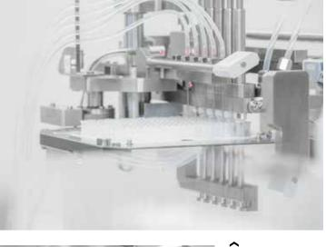
Als Standard-Dosiersystem verwendet USV in der OPTIMA SV125 Rotationskolbenpumpen. Darüber hinaus kann USV jederzeit auf ein fünfstelliges Peristaltikpumpensystem zurückgreifen.
