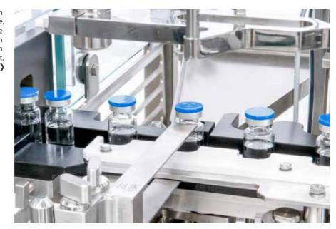
Beim Entpacken der "ready to use" angelieferten Vials wird noch auf Automatisierung verzichtet. Die Beutel werden innerhalb der Containment-Umgebung manuell entfernt.
