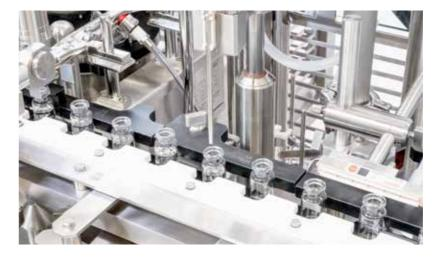
Mit Funktionen wie Redosing on Request, bei der unzureichend befüllte Vials an der IPC-Stelle nachdosiert werden, werden Produktverluste vermieden.
