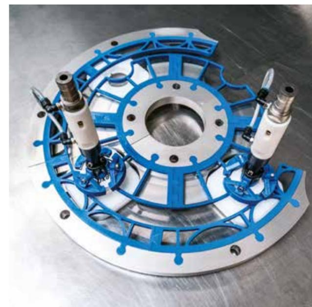
Die neu entwickelten Formatteile sind innerhalb weniger Stunden konstruiert und im 3D-Druckverfahren sofort für den Kunden verfügbar. Sie können weltweit hergestellt werden.
