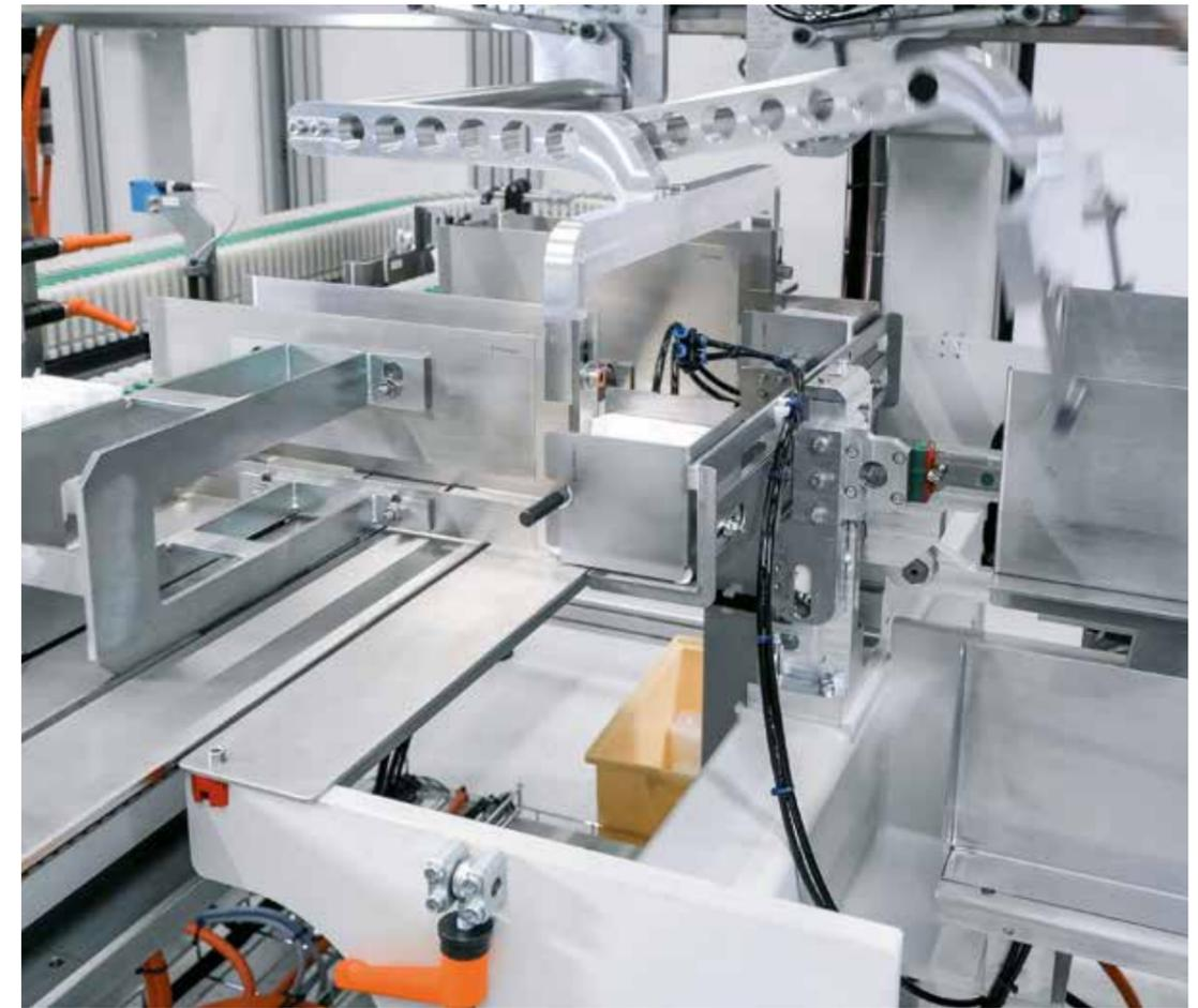
Die OPTIMA FS1 mit der Turnbox. Diese ändert die Ausrichtung eines Bindenstapels und kippt diesen um 90 Grad nach vorne.
