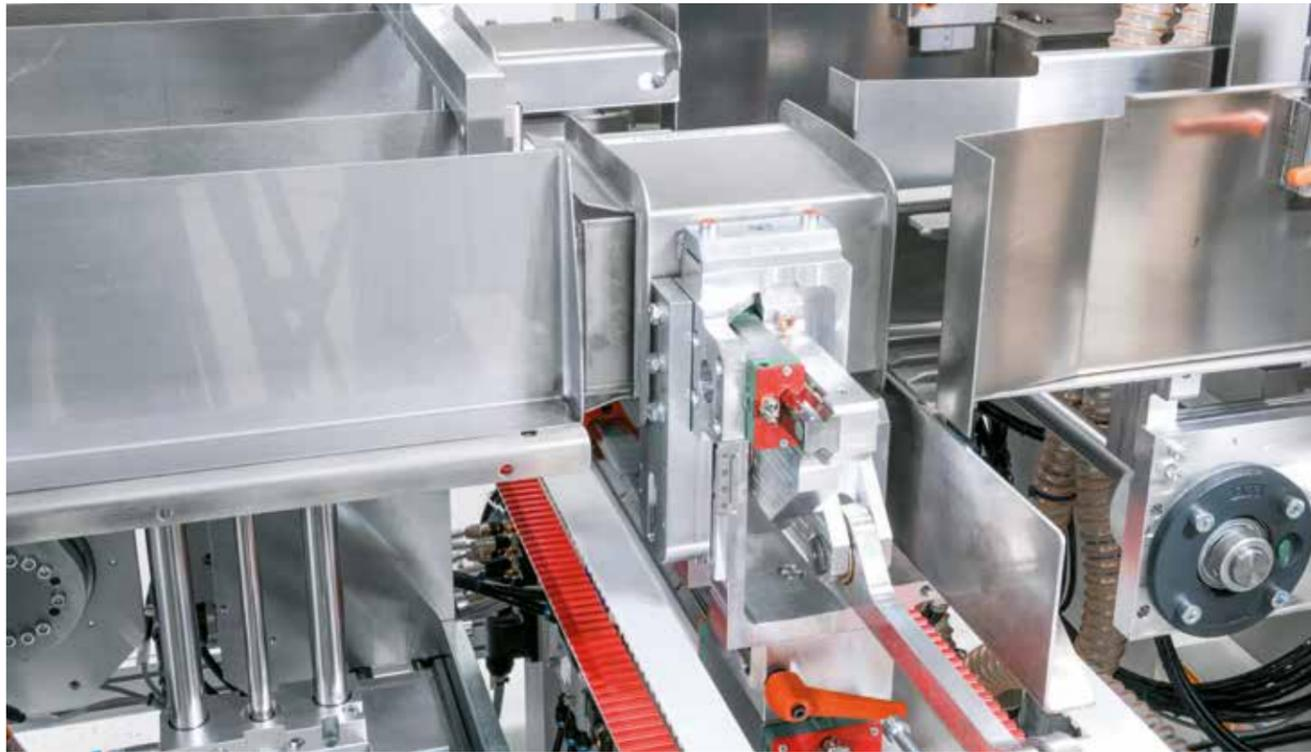
^ In der Schwenkkassette werden die Produkte bei Bedarf gedreht. Zusammen mit der neuen Turnbox (siehe Bild auf Seite 23) lassen sich alle Produktausrichtungen realisieren – ohne Modulwechsel.
