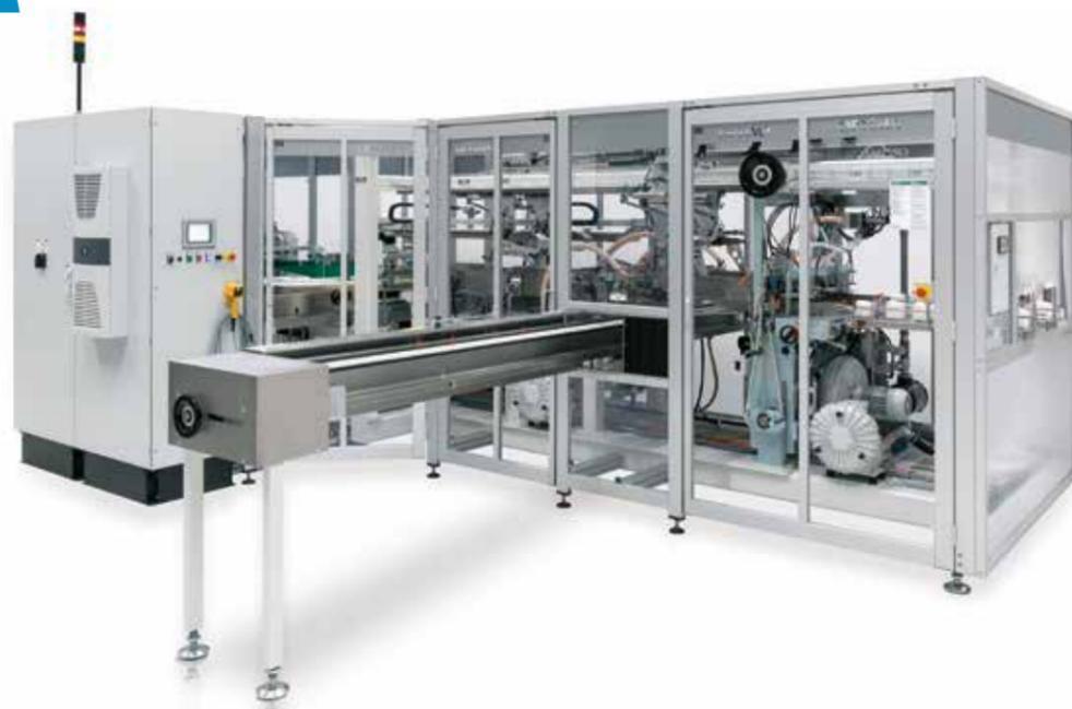
Die Standardversion der OPTIMA FS1 erreicht im Einschuss eine Leistung von 1.000 Damenbinden pro Minute. Bis zu 60 Packungen werden pro Minute hergestellt.
