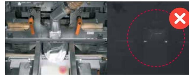
Durch die Wärmebild-Kamera (rechts) können Unterschiede (Bild oben zu unten) in der Schweißnaht auch bei Hochgeschwindigkeit erkannt werden.
